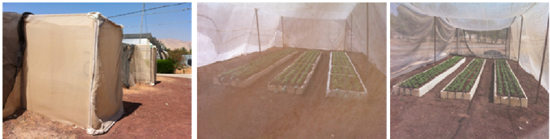
איור 1. מבנה ניסוי התמודדות עם כנימת עש הטבק בבזיל במו"פ הבקעה 2013 (למעלה). מבנה 17 מש (למטה בצד ימין), מבנה 50 מש (למטה באמצע) וכניסות כפולות למבנים (למטה בצד שמאל)
