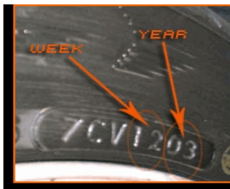
תאריך הייצור על גבי הצמיג 1203 (שבוע 12 שנת 2003)
